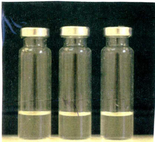
Figura 9: Microcosmos utilizados nos experimentos de biodegradação contendo 5mL de meio MSB.
