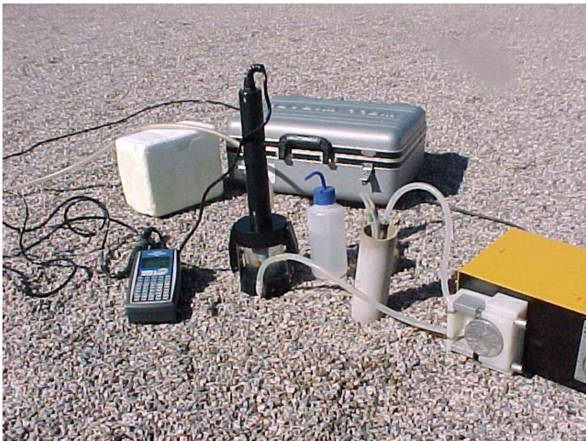
FIGURA 3.5 - Equipamentos utilizados no campo para a coleta das amostras
