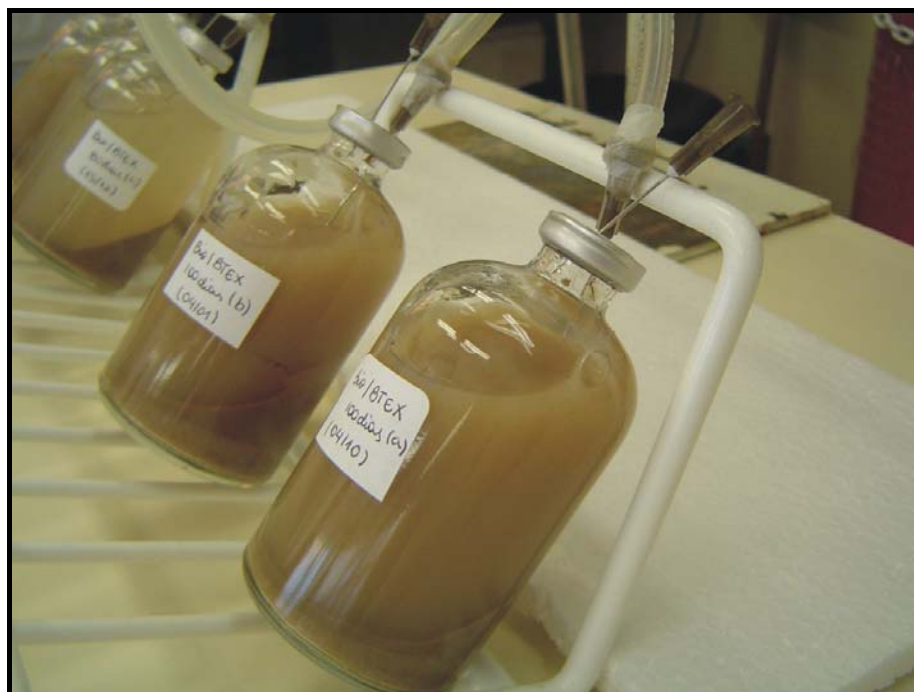
Figura 3.4 - Procedimento de desaeração dos microcosmos anaeróbicos.
