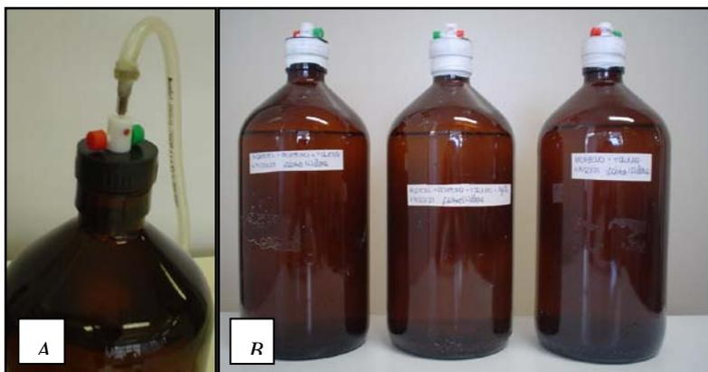
**Figura 3.1** – Microcosmos utilizados no experimento. Em A o microcosmo está sendo desaerado com  $N_2$ . Detalhe para a tampa utilizada no experimento. Em B os microcosmos estão prontos para serem incubados.
