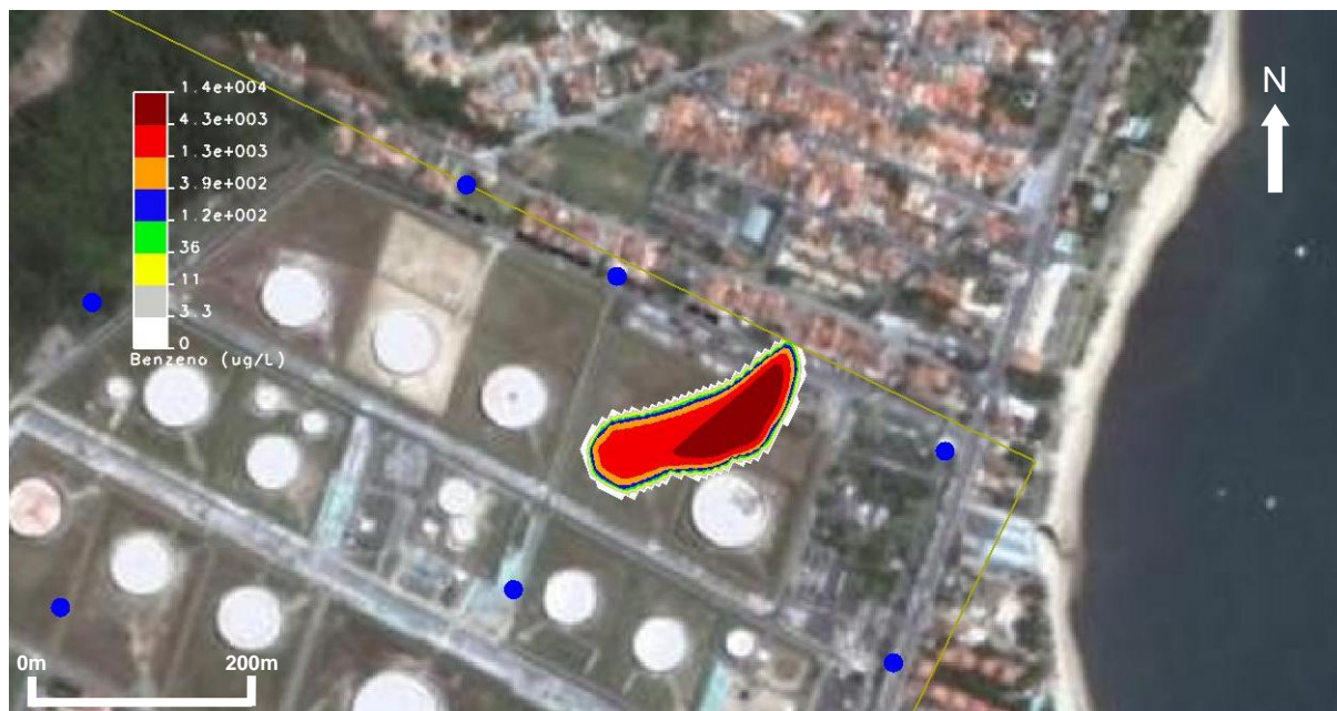
Figura 8 – Pluma de contaminação de benzeno, 56 meses após o vazamento, com extensão de, aproximadamente, 200m. Pluma saindo dos limites do terminal e atingindo os bairros vizinhos.
