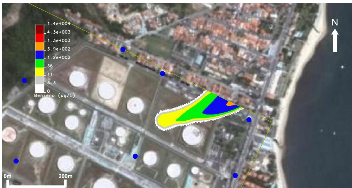
Figura 9 - Pluma de contaminação de benzeno 20 anos após o vazamento, migrando em direção à praia e já fora dos limites do terminal.
