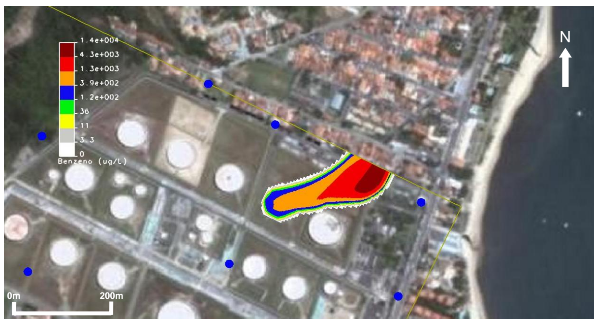
Figura 12 - Pluma de contaminação de benzeno 10 anos após o vazamento, sem a instalação da barreira hidráulica. Extensão da pluma maior que 200m.
