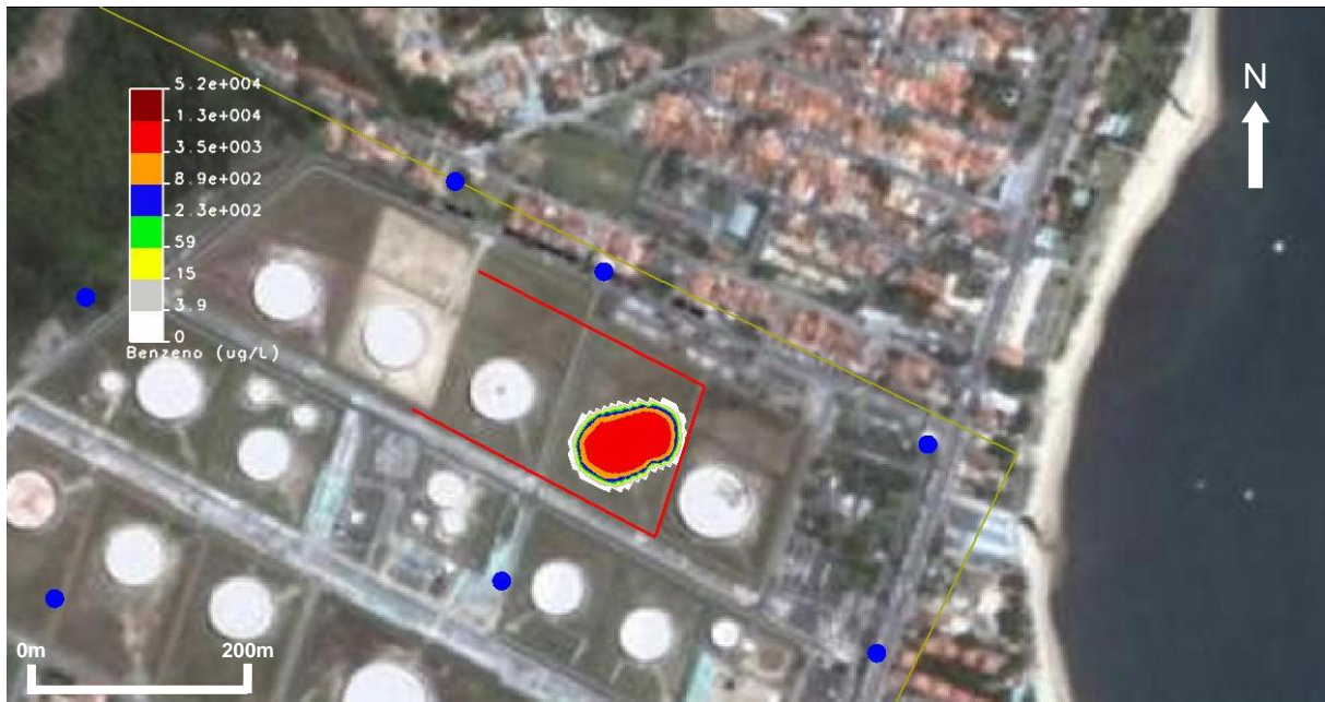
Figura 10 – Pluma de contaminação de benzeno no instante de instalação da barreira hidráulica, 12° mês após o vazamento. Extensão da pluma de, aproximadamente, 80m.
