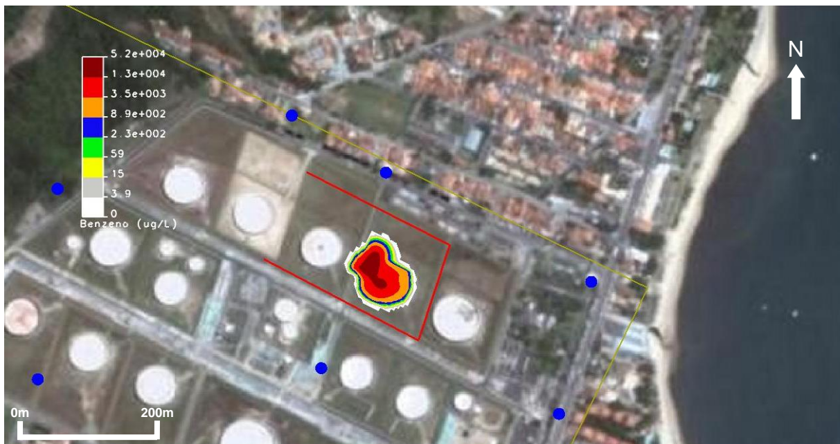
Figura 11 – Pluma de contaminação de benzeno contida pela barreira hidráulica 10 anos após o vazamento. Extensão da pluma de, aproximadamente, 70m.
