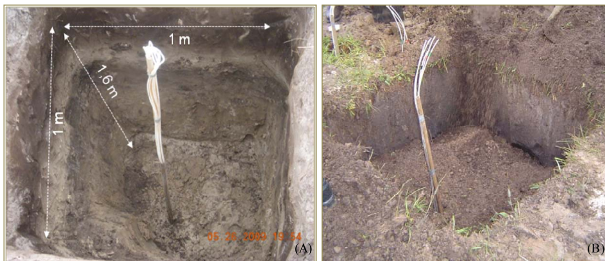
Figura 12 - (A) Buraco de aproximadamente de 1,60 m de profundidade com camadas argilosas; (B) Cobertura do buraco após a liberação.
