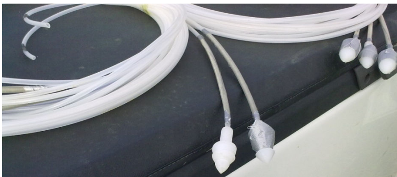
Figura 6 - Detalhe do tubo de coleta da água subterrânea.
