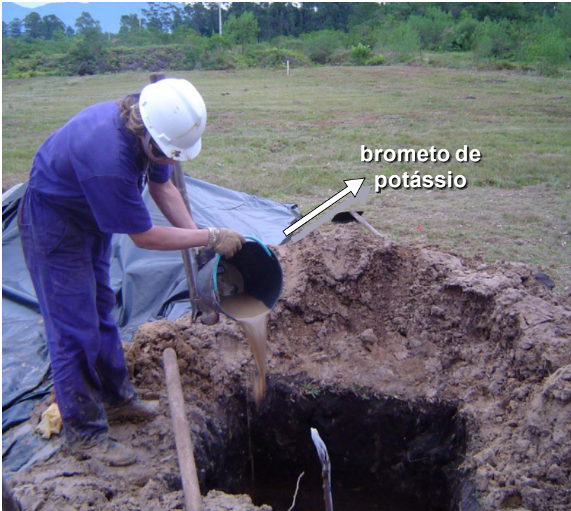
FIGURA 3.11 – Liberação de agente traçador na região da fonte.
