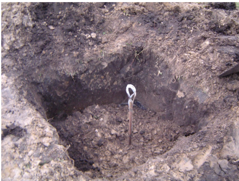
FIGURA 3.12 – Cobertura da região da fonte com o solo nativo.
