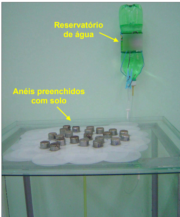
FIGURA 3.4 – Amostras de solo nos anéis metálicos dispostas sobre a mesa de tensão para determinação da porosidade efetiva.
