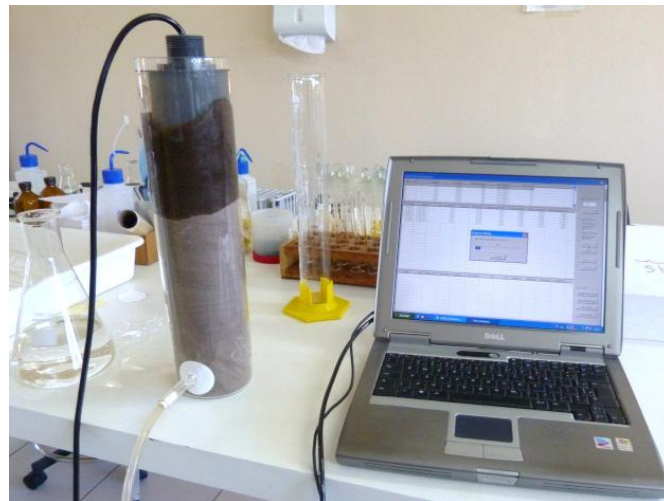
Figura 1 - Experimento de laboratório para a determinação da fração volumétrica de etanol com solo da área experimental Fonte: Próprio autor.
