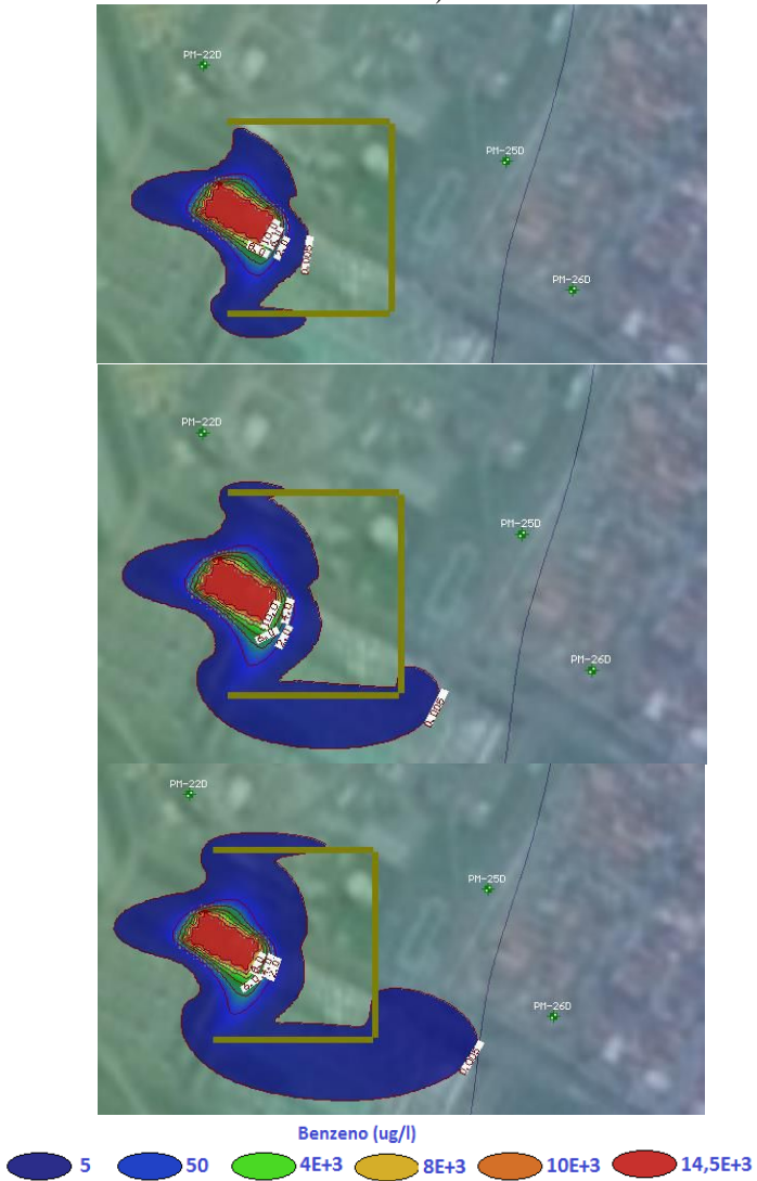
Figura 41 - Pluma de simulação de benzeno (gasolina pura) nos tempos 5, 10 e 15 anos após instalação da barreira física - Visual MODFLOW (1 camada).
