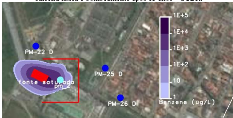
Figura 44 - Pluma de simulação de benzeno (gasolina pura) contida pela barreira física e bombeamento após 15 anos – SCBR.
