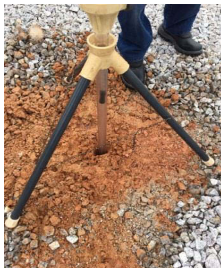
Figura 4.6. Ensaio com o permeâmetro Guelph.
